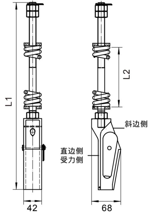
曳引带端头固定装置外形尺寸图
